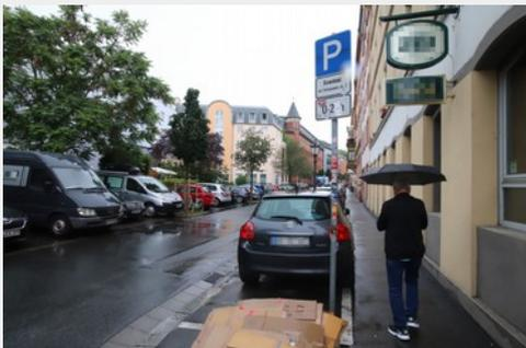
Auf der nördlichen Straßenseite ist das Parken für Anwohner mit entsprechendem Parkausweis in den markierten Flächen auf dem Gehweg freigegeben. Dadurch wird der Gehweg in weiten Teilen auf 1,20 Meter Breite verengt. Dieser Gehweg ist ebenfalls asphaltiert, aber befindet sich in ordentlichem Zustand. Während des Fach-Fußverkehrs-Checks waren zwei Mülltonnen auf dem Gehweg vor Haus Nr. 3 abgestellt. Für eine Person im Rollstuhl beispielsweise war hier zu diesem Zeitpunkt kein Durchkommen möglich.
