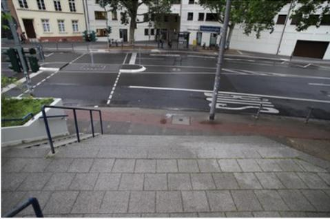
**Empfehlungen:** In der Diskussion vor Ort sprachen sich die FVC-Teilnehmer überwiegend dafür aus, den Radverkehr auf der Busspur zu führen, was von FUSS e.V. ebenfalls vertreten wird. In diesem Sinne sollten die roten Pflastersteine auf dem südlichen Gehweg entfernt und auf der Busspur einige Fahrrad-Piktogramme aufgebracht werden.
